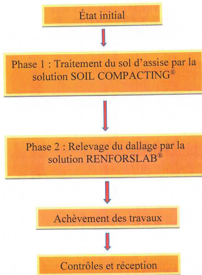
SCHEMA N°5 : Traitement du sol et relevage d'un dallage affaissé dans le cadre d'un défaut de portance
